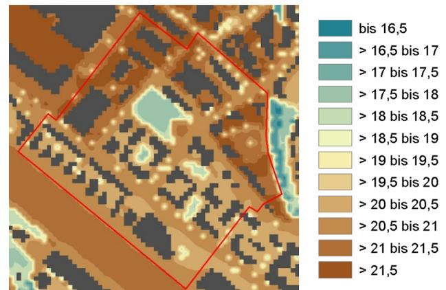
Abb. 2: Nächtliche Lufttemperatur, Plan-Zustand (in °C, in 2 m Höhe)
