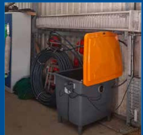
Abb. 6: Kompressor in schallgedämpfter Kiste
