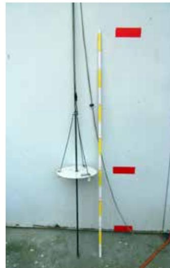
Abb. 3: Sedimentmessstab
