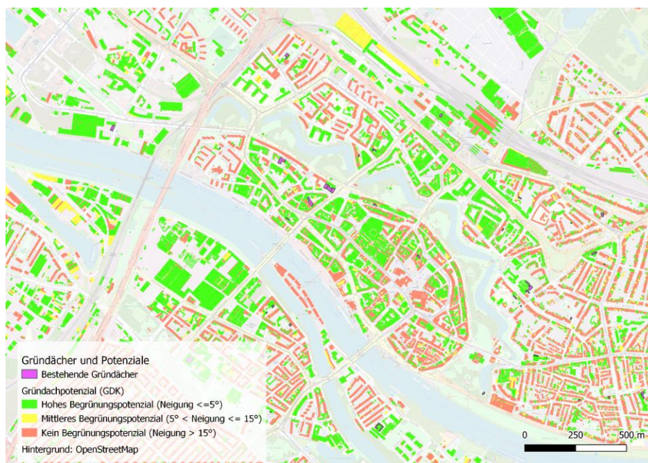
Abbildung 6: Bestehende Gründächer und Gründachpotenziale in Bremen Mitte
