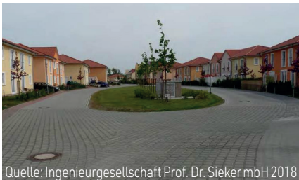
Quelle: Ingenieurgesellschaft Prof. Dr. Sieker mbH 2018 Beispiel für einen versickerungsfähig ausgeführten Wohnweg
